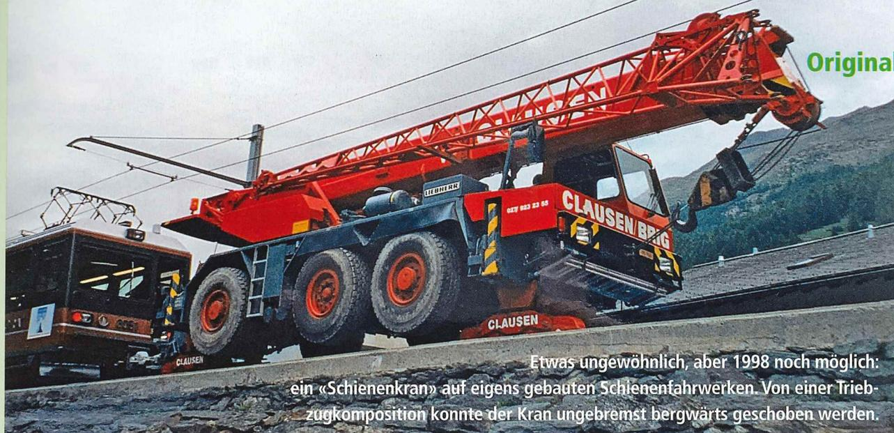
Etwas ungewöhnlich, aber 1998 noch möglich: ein «Schienenkran» auf eigens gebauten Schienenfahrwerken. Von einer Triebzugkomposition konnte der Kran ungebremst bergwärts geschoben werden.
