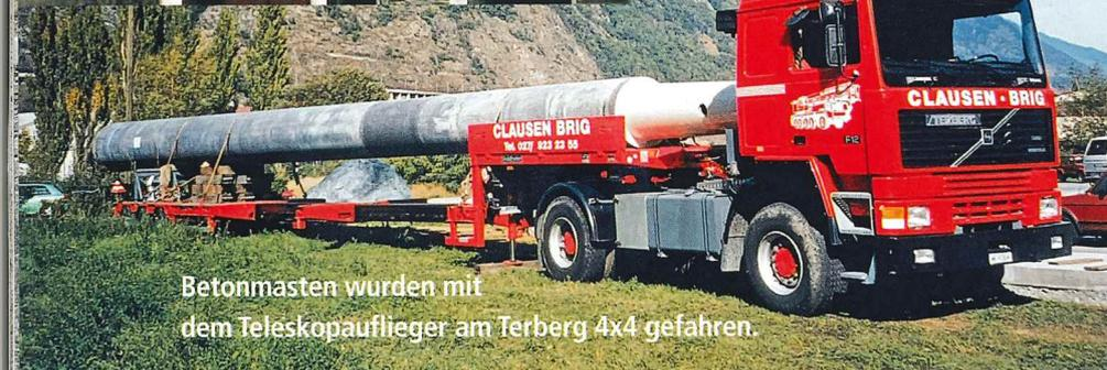
Betonmasten wurden mit dem Teleskopauflieger am Terberg 4x4 gefahren.
