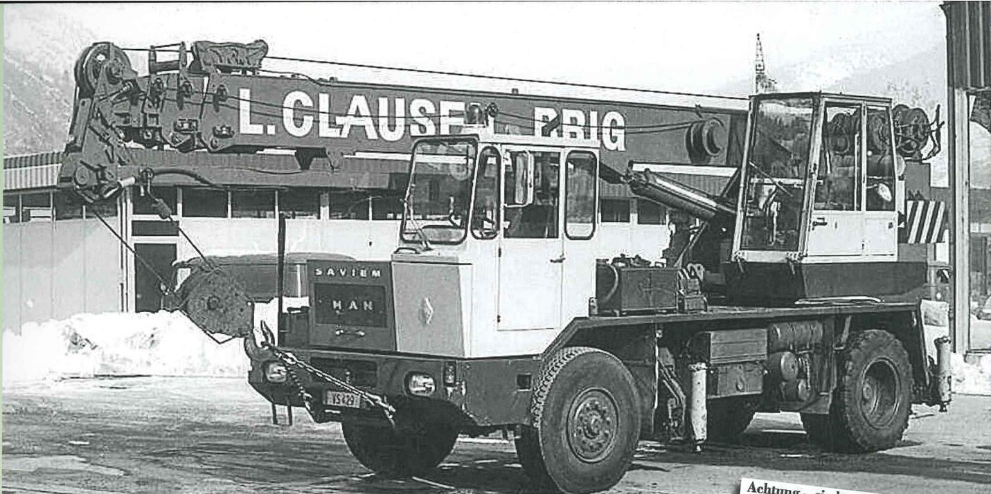
Der erste Kran, ein PPM 1507 auf Saviem-Chassis mit MAN Motor.
