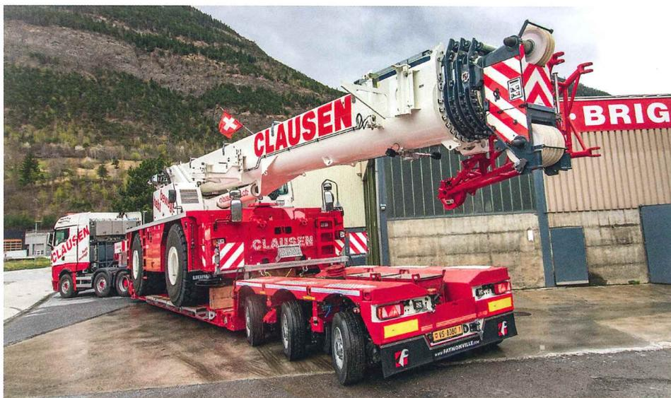
Der Geländekran LRT 1090-2.1 wird mit Tieflader auf öffentlichen Straßen transportiert.
